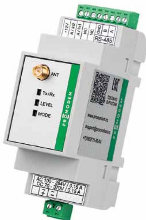
Рис. 8. Радиомодем PROMODEM ZigBee с RS-485, двумя входами 4–20 мА для датчиков и встроенным источником ~85...264 В AC; температура эксплуатации – от –40 до +70 °C; крепление на DIN-рейку
