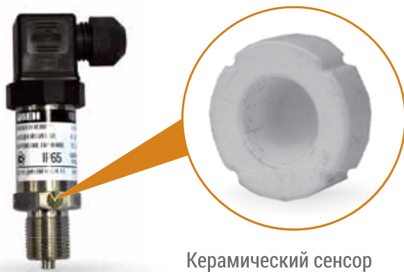
Рис. 2. Тензорезистивный керамический сенсор в датчике давления ОВЕН
