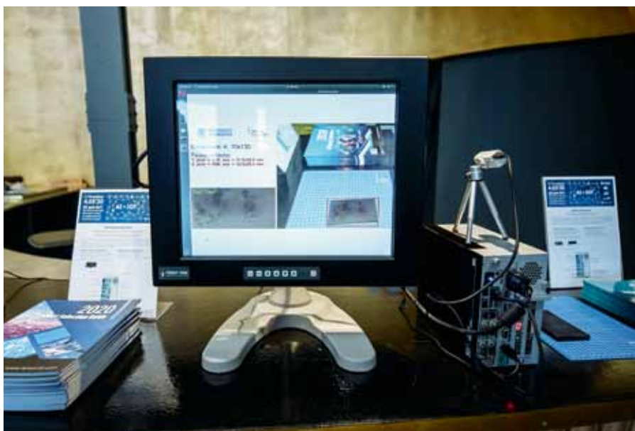
Рис. 2. Оптический дефектоскоп имитирует работу системы контроля качества, использующей методы неразрушающего контроля. Благодаря преимуществам алгоритмов глубокого обучения с высокой точностью выявляет поверхностные дефекты
