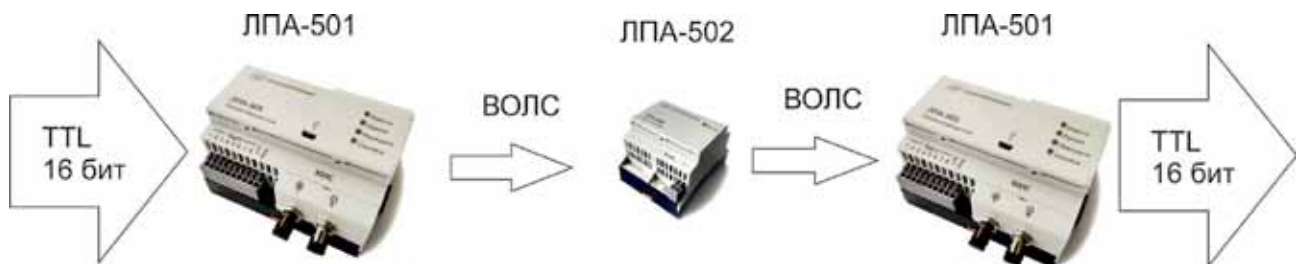
Рис. 1. Линия передачи данных, построенная с помощью приемопередатчика ЛПА-501 и ретранслятора ЛПА-502
