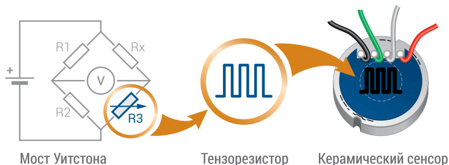
Рис. 1. Технология изготовления керамических сенсоров, основанная на мостовой схеме Уитстона
