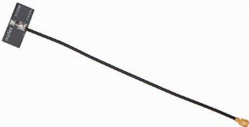
Рис. 6. Антенна Molex для ультраширокого диапазона UWB (5,8...8,5 ГГц): гибкая, 7,6 × 16,4 мм, с кабелем 100 мм, может оконцовываться соединителями U.FL/I-PEXMHF
