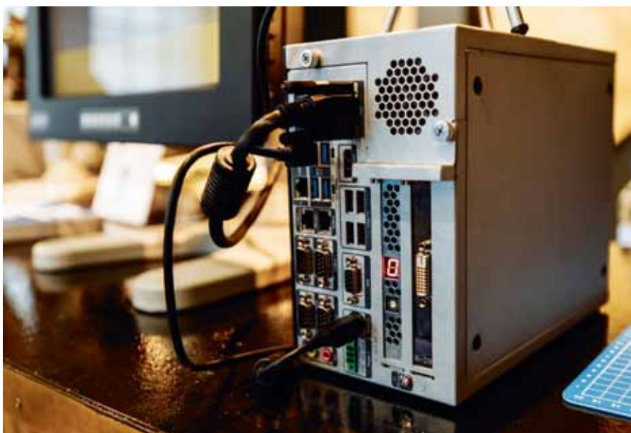
Рис. 3. Встраиваемый компьютер TANK-870AI-i5/8G/2A, входящий в комплект разработчика IEE Tank AioT Developer Kit
