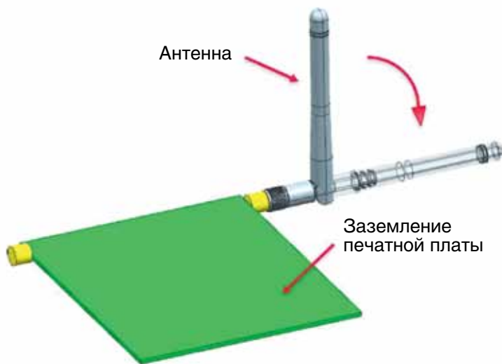
Рис. 8. Схема установки корпусной наружной ISM-антенны
