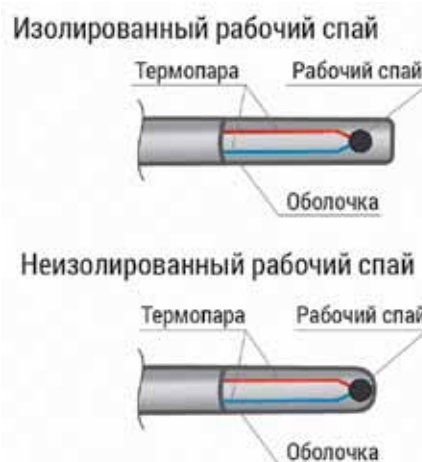
Рис. 3. Термоэлектрический преобразователь с изолированным и неизолированным спаем
