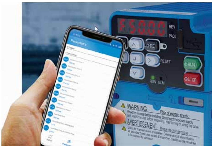
Рис. 2. Настройка частотного преобразователя Q2V через мобильное приложение
