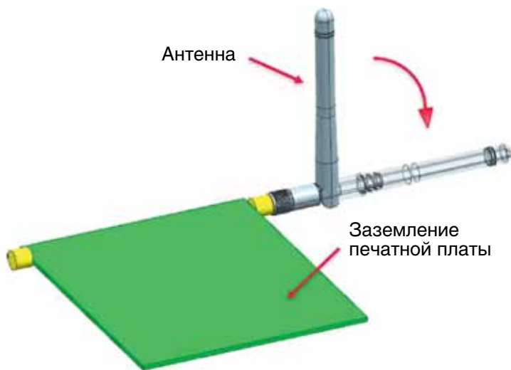
Рис. 8. Схема установки корпусной наружной ISM-антенны
