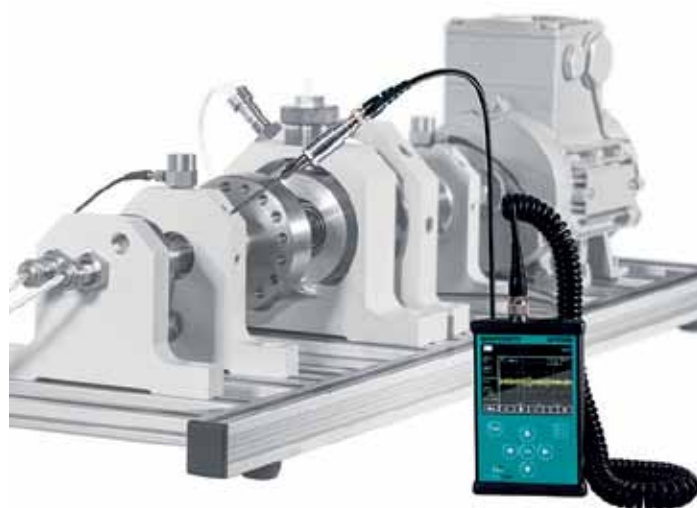
Рис. 1. Измерение вибрации с помощью виброметра AP5500
