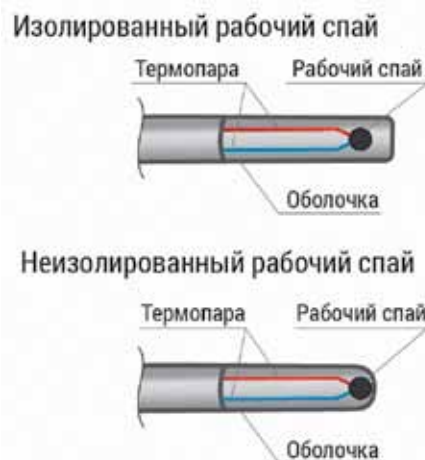
Рис. 3. Термоэлектрический преобразователь с изолированным и неизолированным спаем
