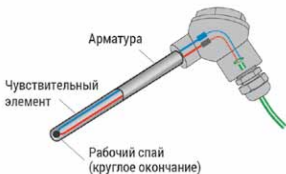
Рис. 2. Термоэлектрический термометр
