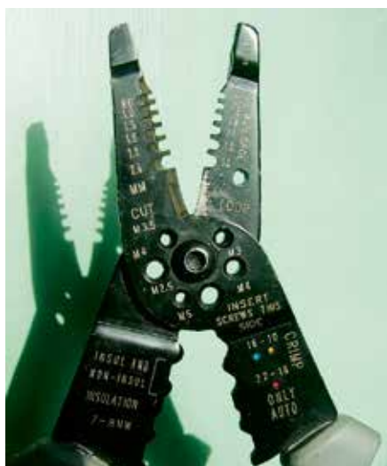
Рис. 2. Диапазон поддерживаемых сечений стриппера
