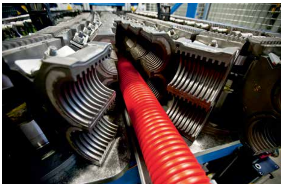
Рис. 3. Производство двустенных гофрированных труб «Промрукав»
