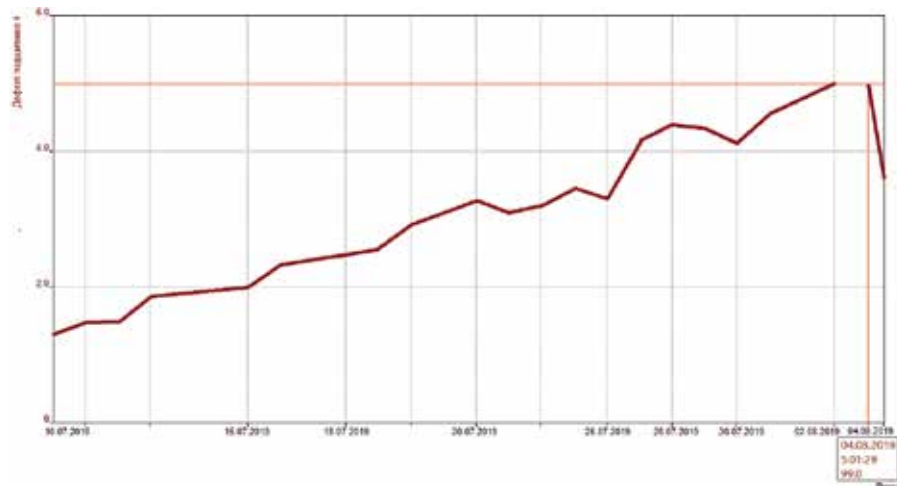
Рис. 5. Тренд развития дефекта подшипника
