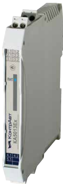
Рис. 3. Внешний вид барьера искрозащиты – разветвителя сигнала 1 в 2 КА5013Ех, выпускаемого НПФ «КонтрАвт»
