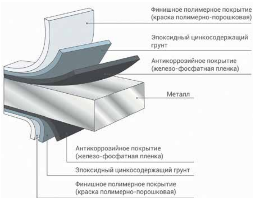
Рис. 3. Покрытие металлического шкафа по новой технологии
