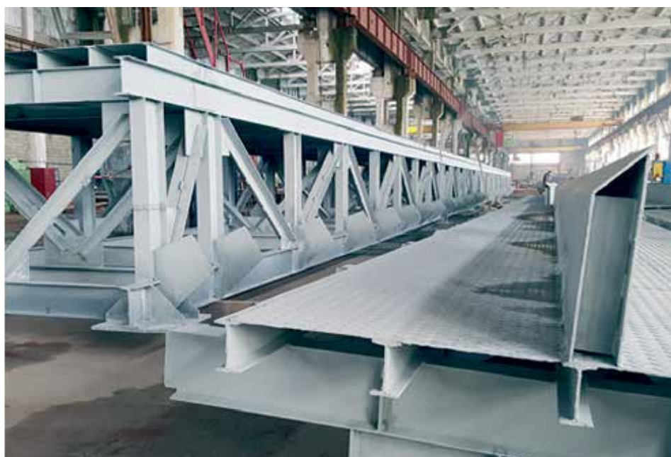
▲ Металлоконструкции, защищенные составом Zincker: слева – автомобильный мост; справа – башня для крепления дымовых труб
