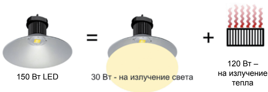
Рис. 5. Распределение мощности светодиодного светильника на излучение света и излучение тепла
