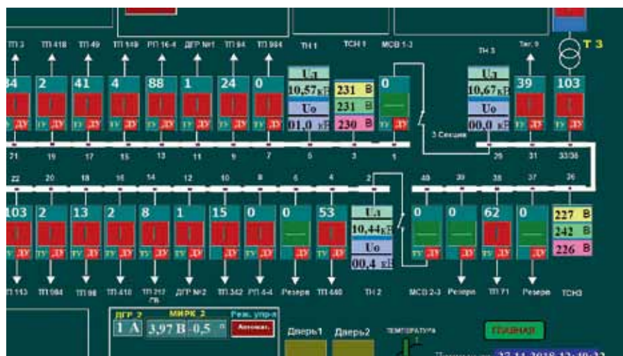
Рис. 5. Подключение МИРК-5 к АСУ ТП ПС «Новая» по Modbus RTU
