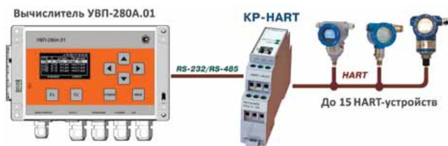
Рис. 2. Подключение контроллера KP-HART к вычислителю линейки УВП-280 в системе коммерческого учета
