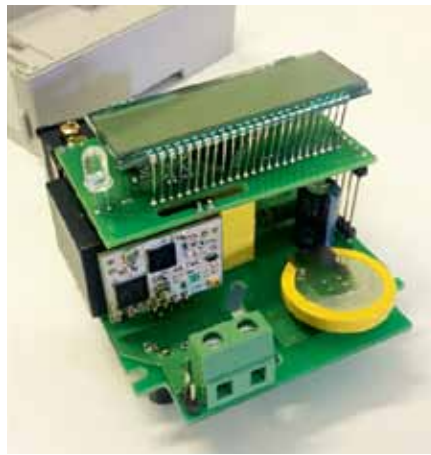
▲ LoRaWAN-модем в счетчике ЦЭ2726А: исполнение на DIN-рейке
